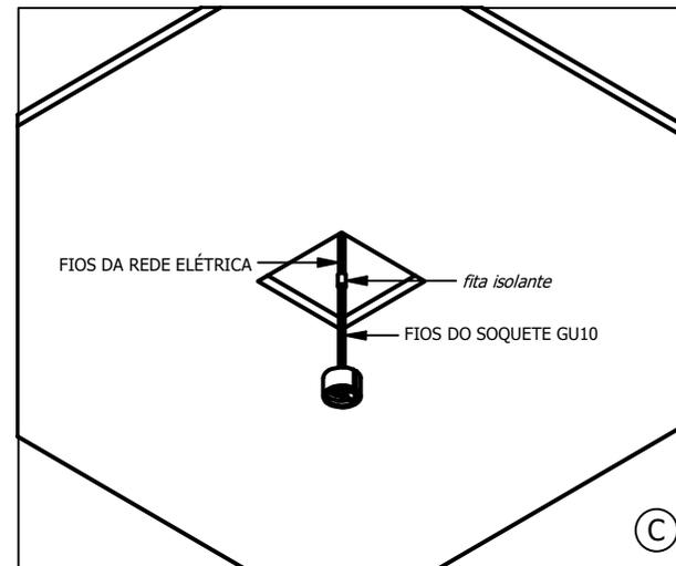
**Atenção:** desligue sua rede elétrica para prosseguir com as próximas etapas de instalação.
