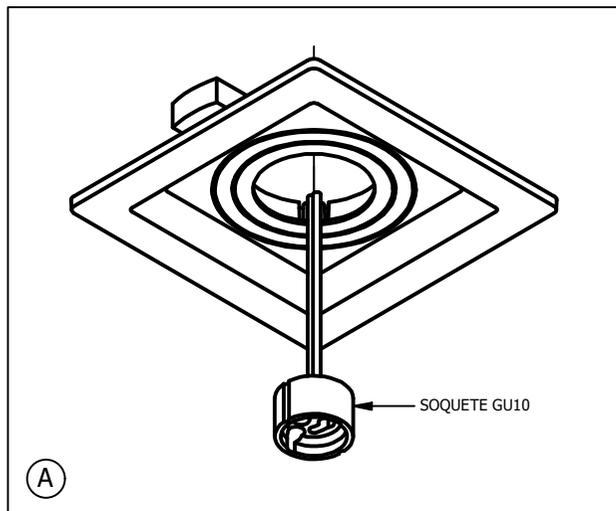
**1º** - O Spot virá com todos os seus componentes já previamente montados, retire apenas o SOQUETE GU10 da embalagem para iniciar sua instalação.
