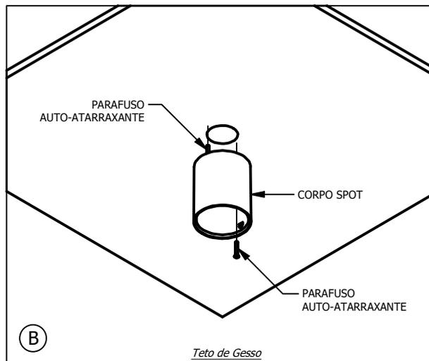
**2º** - Fixe o CORPO SPOT no teto utilizando dois PARAFUSOS AUTO-ATARRAXANTES (**Não inclusos na embalagem**). Recomendamos Parafusos M3 de 15 mm à 25 mm de comprimento. Para instalar no gesso, lembre-se de comprar as buchas específicas para gesso, se for alvenaria, pode ser utilizada a bucha normal. Já em madeira não é necessário o uso de bucha para a fixação do parafuso.
