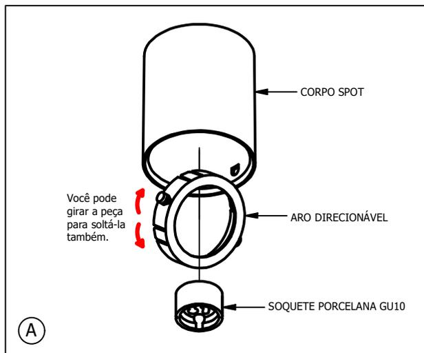
**1º** - O Spot virá com todos os seus componentes já montados, desencaixe todas as peças para iniciar sua instalação. Remova primeiro a peça ARO DIRECIONÁVEL e em seguida o SOQUETE PORCELANA GU10 da peça CORPO SPOT. O ARO DIRECIONÁVEL é fixado por encaixe, localize o lado do pino e puxe levemente para o lado, até soltar.
