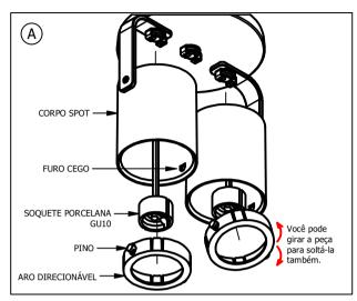
1º - O Spot virá com todos os seus componentes já montados, desencaixe as peças indicadas a seguir para iniciar sua instalação. Remova primeiro a peça ARO DIRECIONÁVEL e em seguida o SOQUETE PORCELANA GU10 da peça CORPO SPOT. O ARO DIRECIONÁVEL é fixado por encaixe, localize o lado do pino e puxe levemente para o lado, até soltar.
