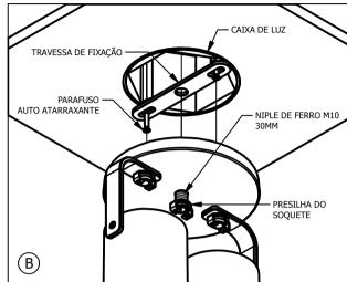
2º - Desenrosque o NIPLE DE FERRO M10 30MM e a PRESILHA DO SOQUETE do Conjunto, isto facilitará a remoção da TRAVESSA DE FIXAÇÃO.
