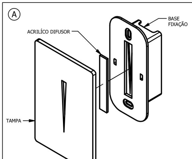
**1º** - O Balizador virá com todos os seus componentes já montados, desencaixe as peças indicadas a seguir, para iniciar sua instalação. Remova primeiro a peça TAMPA, seguida do ACRILÍCO DIFUSOR que está colado pelo adesivo "RETIRE A PELÍCULA".
