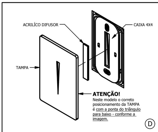
**4º** - Após o encaixe da BASE FIXAÇÃO na CAIXA 4x4, insira o ACRILÍCO DIFUSOR no mesmo espaço que estava antes - **ATENÇÃO!** Retire a película do acrílico, como foi indicado no adesivo.
